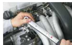
Utiliser UNIQUEMENT une clé dynamométrique pour le montage et démontage des bougies de préchauffage.
